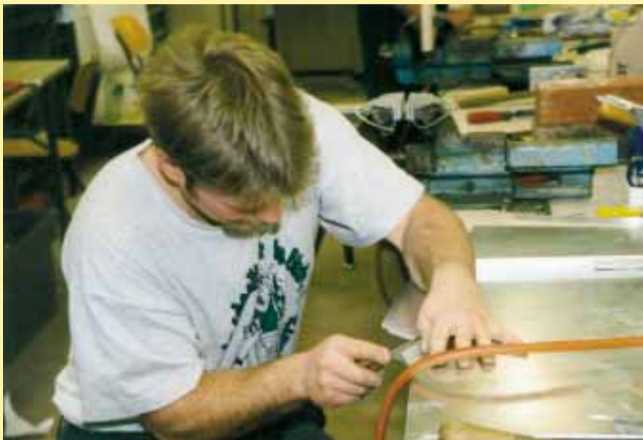
Mittels Schablone werden die einzelnen Teile angeformt
