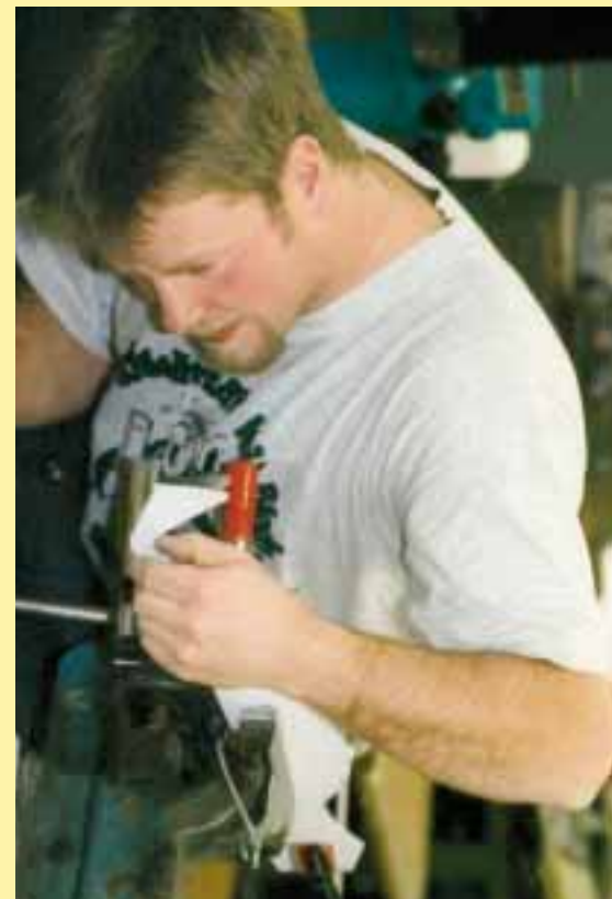
Die einzelnen Segmente werden mit Feile und Dreikantschaber entgratet und anschließend angefast
