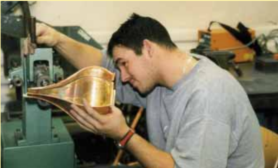
Das konkav und konvex geschwungene Mittelstück ist durch Falze verbunden worden . . .
