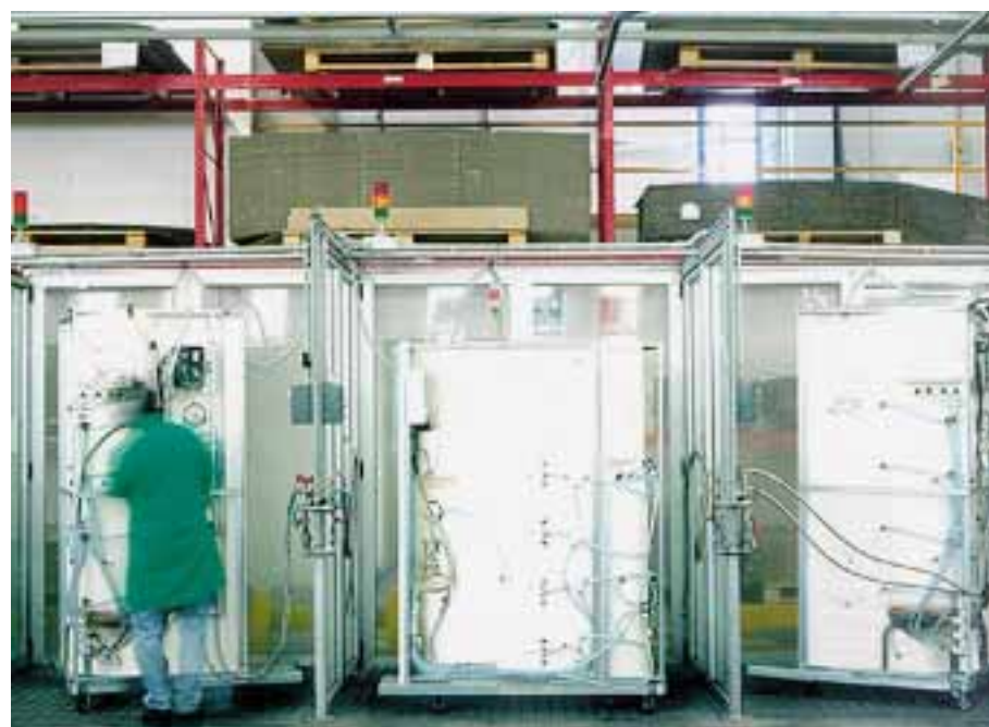
Neben der Oberflächenqualität und der Dichtigkeit werden Elektroinstallation und die Programmierung der elektronischen Bauteile in einer Betriebssimulation überprüft
