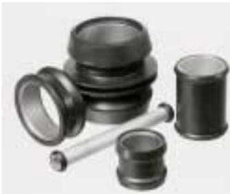
Rohrzwischenstück, Dichtung und Anschlagdämpfer in einem einzigen Bauteil. Die Simrit Plug & Seal Rohrstücke können aus Stahl, Aluminium oder Kunststoff gefertigt werden. Für die Gummierung, die Dichtwulste und die Anschlagdämpfung stehen Elastomere zur Verfügung. *Simrit*
