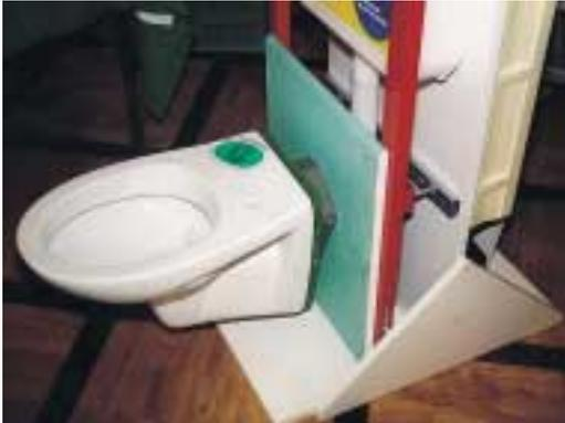
geelement montiert und bleibt mit dem WC während der gesamten Bauzeit montiert. Fliesenarbeiten können dennoch ungehindert ausgeführt werden. Der Fliesenleger fliest bis an die Kante des Bau-WC-Halters. Zur Fertigmontage entfernt der Installateur den Halter wieder, das WC überdeckt die Fliesenkante. Die Anschlußgarnitur des WCs kann wieder verwendet werden.
