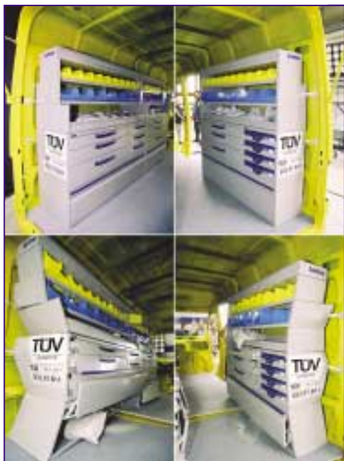
Der Crash-Test zeigt: Nur bei entsprechend ausgelegter System-Einrichtung bleibt die Einrichtung samt Beladung an ihrem Platz
