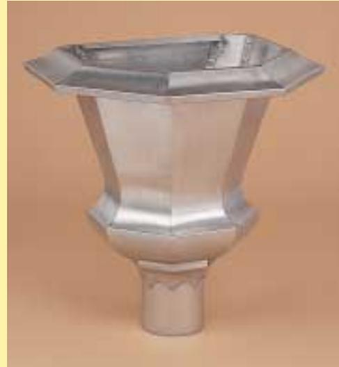
Innenschale sowie für den Boden hat Berger reines Zinnblech von 1 mm Dicke verwendet. Der untere Abschluß des Säulenkörpers wird durch ein genutetes Messingrohr  $15 \times 1$  mm gebildet. Ein rustikales Schliffbild der Zinkoberfläche unterstreicht den antiken Charakter der Obstsäule.
