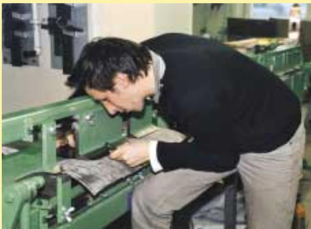
Das für den Erkerbereich verwendete Oxid-Kupfer wurde im Sichtbereich durch Kerbstahl strukturiert
