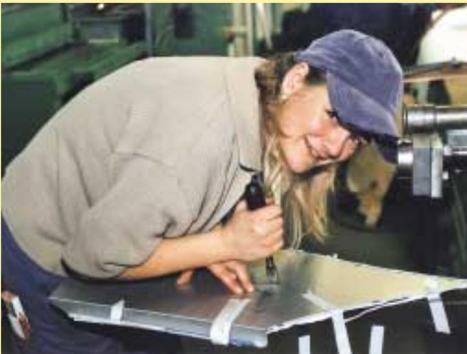
Mit Kerbstahltechnik wird in der mittleren Schare über der Eingangstüre der Name „Laila“ eingearbeitet . . .
