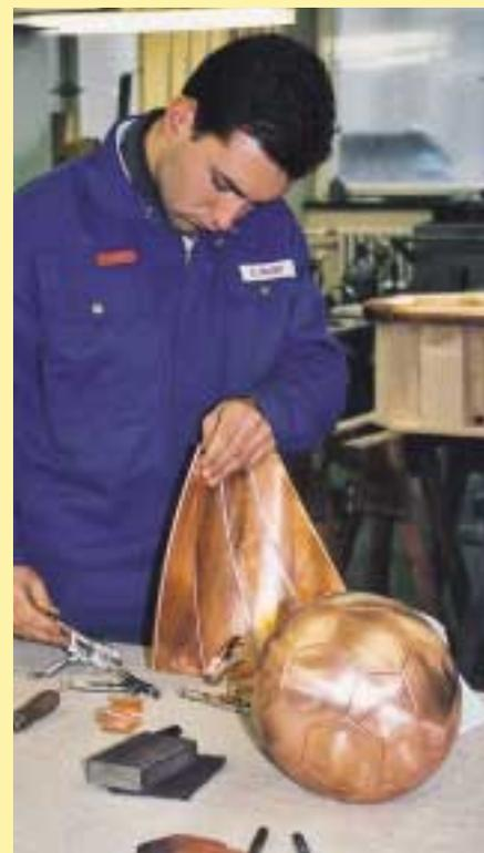
Der Ball wird mittels innenliegendem Querfalz mit dem Pokalfuß verbunden
