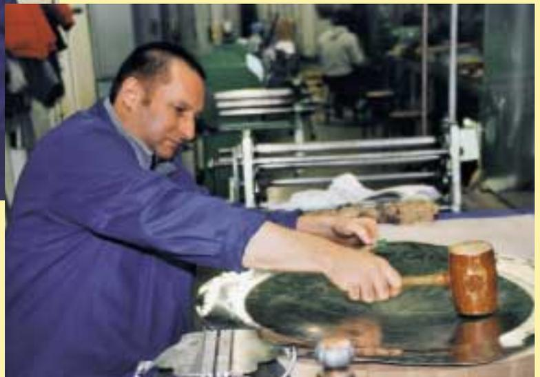
Die Innenschale ist auf einer mitgebrachten Treibform getrieben und besteht aus reinem Zinnblech von 1 mm Dicke
