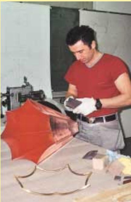
Bevor der obere Kantenabschluß aus geschlitztem Messingrohr aufgesteckt werden kann, sind noch kleinere Schleifarbeiten erforderlich
