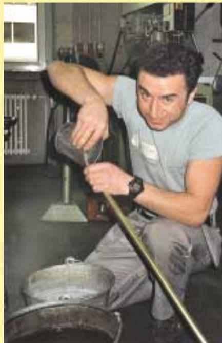
Das Messingrohr für den zweiteilig gebogenen Schirmstock muß zunächst mit Sand gefüllt und verdichtet werden, bevor . . .
