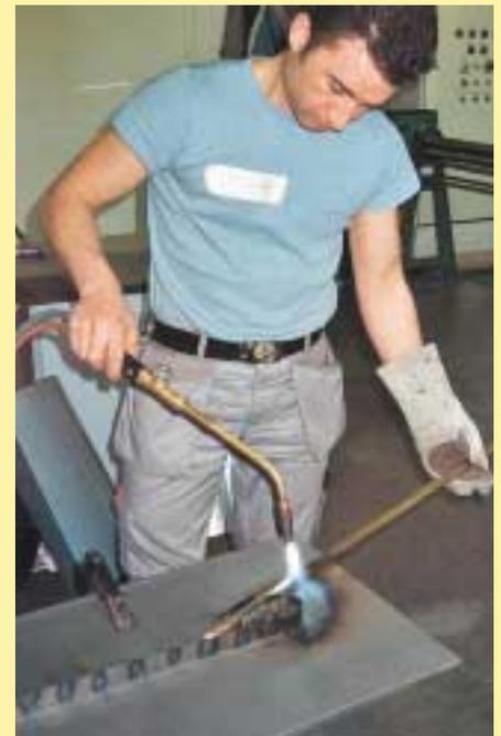
. . . es über eine selbst gefertigte Form gebogen werden kann
