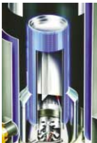
Verbrennung mit blauem Strahlenmantel und kurzen Flammkegeln
