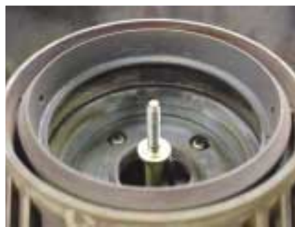
Nach dem Praxistest ausgebaute Teile: Vormischkammer und Brennerrohr
