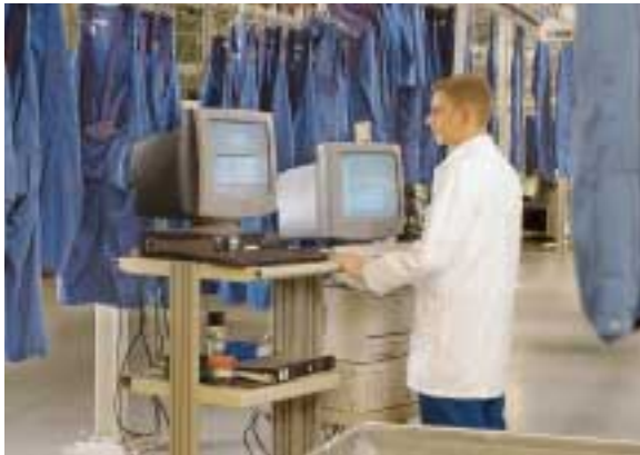
◀ Durch einen Chip im Textil werden die Kleidungsstücke computermäßig erfasst, identifiziert und automatisch sortiert
