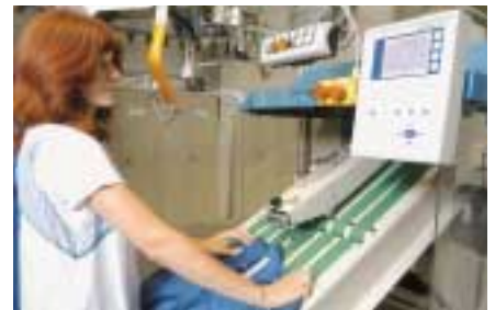
Mit Hilfe spezieller Faltautomaten wird die Wäsche zusammengelegt
