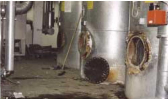
Durch die Explosion des Warmwasserbehälters wurde ein Monteur schwer verletzt und es entstand erheblicher Sachschaden
