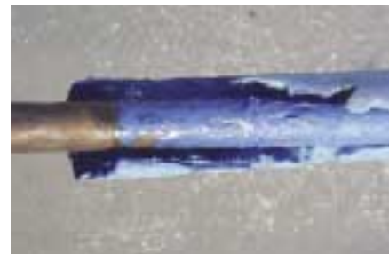
Konventionelle Isolierungen aus der Heizungstechnik halten den hohen Temperaturen in Röhrenkollektor-Anlagen
