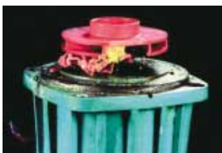
Bei Überhitzung einer Pumpe kann es zu Schmelzprozessen am Kunststoff-Laufrad kommen
