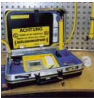
Das LM 03 Touch ist für die Prüfungen an Gasleitungen ausgelegt, kann aber zum Universalmeßgerät „aufgerüstet“ werden
