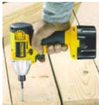
Die 12-Volt-Akku-Schlagschrauber von DeWalt sind für schwere Schraubarbeiten geeignet
