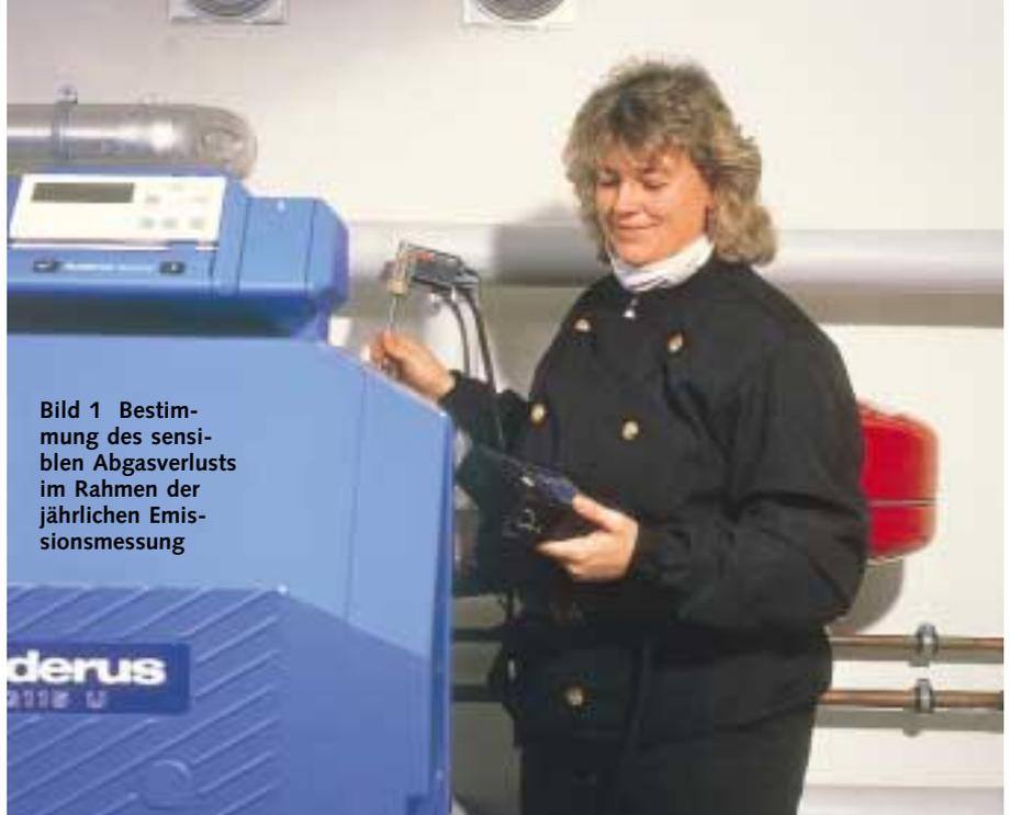
**Bild 1 Bestimmung des sensiblen Abgasverlusts im Rahmen der jährlichen Emissionsmessung**
