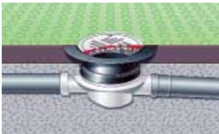
**Bild 6 Ablauf mit Abdichtung durch Bodenbelag**
