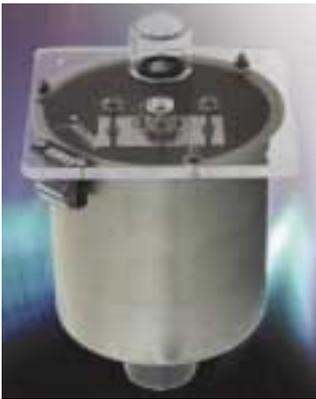
**Meßgerät zur Erfassung von Kondensat aus Brennwertgeräten**
