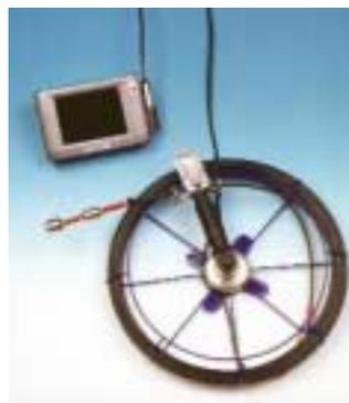
Das Videoinspektionssystem VIS 2000 erlaubt u. a. auch eine visuelle Überprüfung von Abwasserrohren
