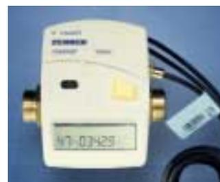
Der Wärmezähler Zelsius zeigt auf Knopfdruck per Stichtag den Zählerstand bzw. Verbrauchswert sowie eine Prüfzahl
