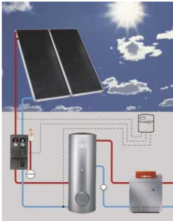
Bild 1 Wesentliche Teile einer bivalenten Anlage: Kollektor, Umwälzpumpe, bivalenter Speicher-Wassererwärmer, Solarregelung und zentraler Wärmeerzeuger
