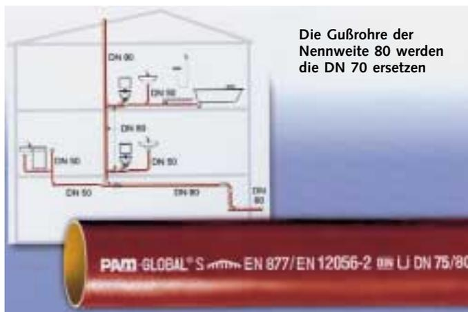
Die Gußrohre der Nennweite 80 werden die DN 70 ersetzen
