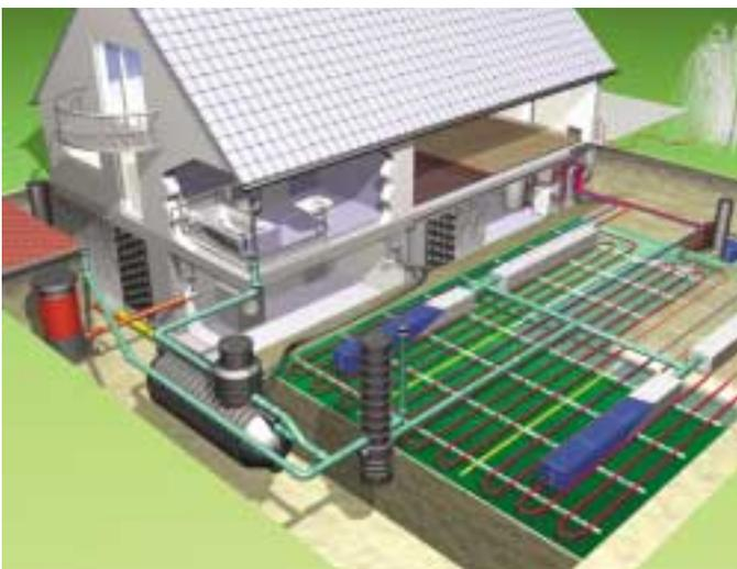
Der Elwa Aqua-Geo-Kollektor nutzt die Erdwärme mit Hilfe der Wärmekapazität des Regenwassers
