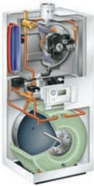
Das Gas-Brennwertwandgerät Vitodens 222 verfügt über einen integrierten 86-l-Trinkwasser-Ladespeicher
