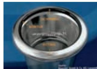
Der Mapress-Kontur-Dichtring wurde an drei Stellen vergrößert, damit im unverpreßten Zustand Undichtigkeiten auftreten
