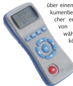
über einen Infrarot-Thermodrucker dokumentiert werden. Ein interner Speicher ermöglicht die Aufzeichnung von Meßwertverläufen mit frei wählbarer Intervallzeit. Weiterhin können Meßdaten über ein Funkinterface zu einem PC oder Laptop gesendet werden. Die mitgelieferte Software ermöglicht den Empfang und die Speicherung der Daten im CSV-Format.
