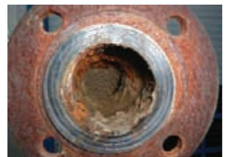
Schlammbildung in Stahlrohrleitung
