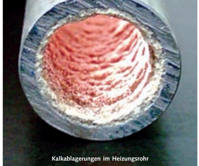
Kalkablagerungen im Heizungsrohr
