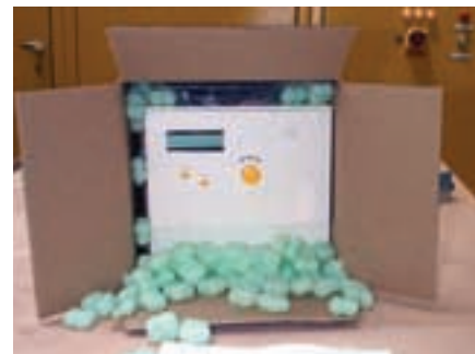
Bild 8 Umweltfreundliche Verpackung: Altpapier-Reißwolfschnitzel anstelle von EPS-Chips als Füllmaterial
