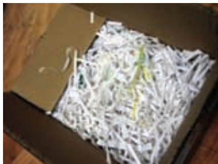
Bild 8 Umweltfreundliche Verpackung: Altpapier-Reißwolfschnitzel anstelle von EPS-Chips als Füllmaterial
