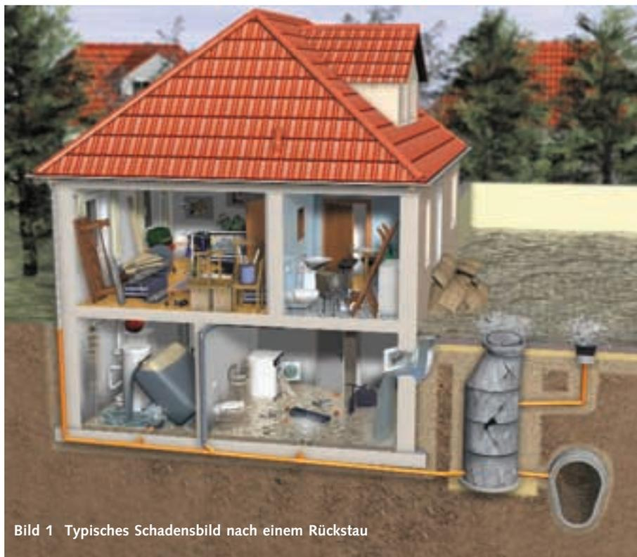
Bild 1 Typisches Schadensbild nach einem Rückstau
