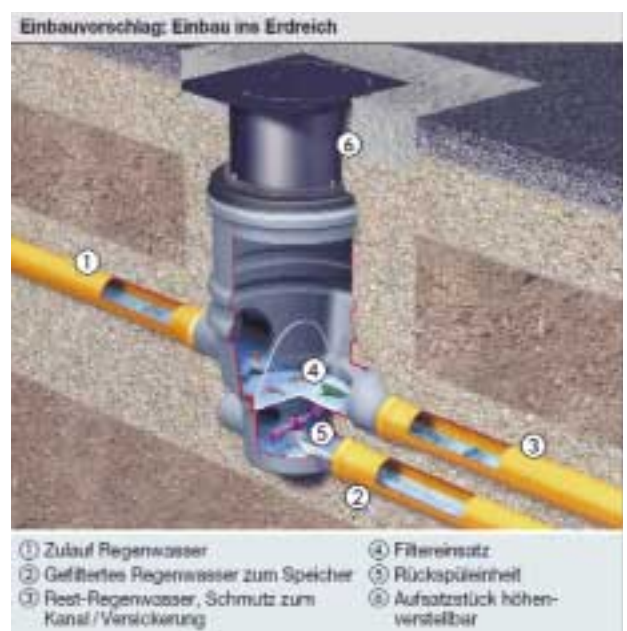
Bild 3 Selbstreinigende Filter spülen mit einem Teil des Regenwassers herausgesiebte Schmutzpartikel in die Kanalisation
