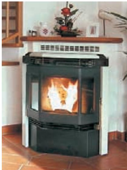
die anderen Räume über einen Wärmetauscher. Die Öfen, die in zwei Ausführungen lieferbar sind, werden über eine Förderschnecke vollautomatisch mit Holzpellets bestückt, die sich in einem integrierten 45 Kilogramm-Vorratsbehälter befinden. Eine Inbetriebnahme der Kaminöfen erfolgt per Knopfdruck mit elektrischer Zündung.
