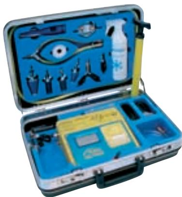
Das Meßgerät LM 06 kann zur Dichtheitsprüfung und Leckmengenmessung an Gasleitungen sowie zur Dichtheitsprüfung von Wasser- und Abwasserleitungen eingesetzt werden. Das neuartig konzipierte Prüfgerät zeichnet sich – laut Anbieter – durch seine einfache Handhabung, Baustellentauglichkeit und hohe Meßgenauigkeit aus. Die Bedienung erfolgt dialoggeführt über Touch Screen. Vor Ort kann der Anwender die zentralen Daten zu Objekt, Zählern etc. einprogrammieren. Das Er-
