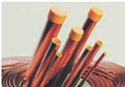
Bild 11 Ob Ring- oder Stangenware: Besonders hinsichtlich der TrinkwV sollte es selbstverständlich sein, daß die Rohre verschlossen geliefert werden
