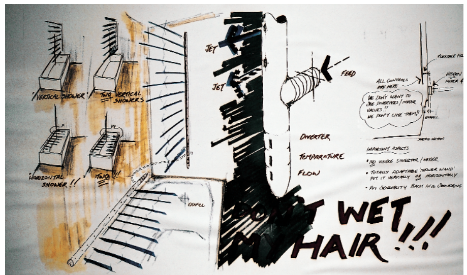
Vision: Die Duschstange von Julian Sharpe kann sowohl horizontal zur Befüllung der Badewanne als auch vertikal zum Duschen verwendet werden
