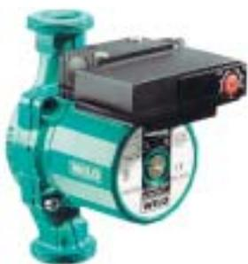
der bei Kesselabsenkungsbetrieb die Leistung der Pumpe automatisch anpaßt, läßt sich über diesen Knopf aktivieren. Die Wilo-Star-E 25 (30)/1-5 eignet sich nach Firmenangaben für Objekte mit einem Wärmebedarf von 20 bis 60 kW, einer max. Förderhöhe von 5 m und einem max. Volumenstrom von 3,5 m<sup>3</sup>/h. Heizungsanlagen mit einer komplexeren Leitungsführung sind dann der Einsatzbereich von ProfiStar von Wilo.
