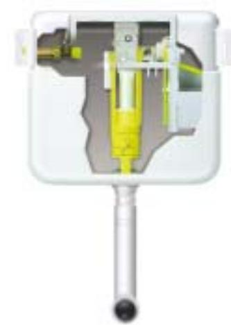
geschlossen werden. Er besitzt eine Wasser sparende 2-Mengen-Spültechnik, deren Kleinspülung auf ca. 3 Liter festgelegt ist. Für die Vollspülung stehen wahlweise die Spülmengen 9, 6, und 4,5 Liter zur Auswahl. Eine variable Betätigungsplatte im typischen Viega-Design, mit kleiner Taste für 3-Liter-Kleinspülung und großer Taste für Vollspülung, runden das Gesamtbild des Spülkastens ab.
