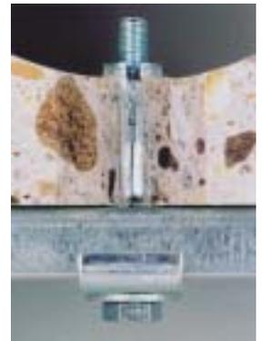
se des Ankers ermöglicht einen größeren Spielraum bei der Platzierung von Befestigungspunkten. Nach Herstellerangaben muß er nicht mittig in die Hohlraumachse gesetzt, sondern kann bis zu einem minimalen Abstand von 50 mm an die Spannstähle herangesetzt werden. Der Anker wird in den drei Größen M 6, M 8 und M 10 galvanisch verzinkt oder für Spezialanwendungen aus nichtrostendem Stahl A 4 angeboten.
