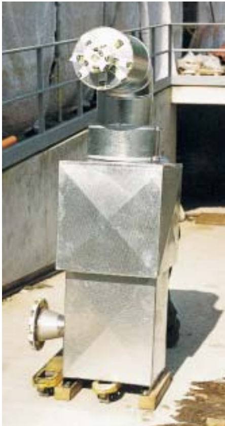
Der Wärmetauscher wird später im Technikraum an den Abgasstutzen der Turbine angeflanscht und mit dem Hausnetz verbunden
