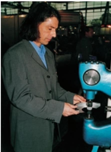
*Nikolas S. Aichele von Dinosaurier Werkzeuge demonstriert am Kraftformer SG 2000 G wie oberflächenschonend das Gerät mit den neuentwickelten Polyamid-Einsätzen arbeitet*
