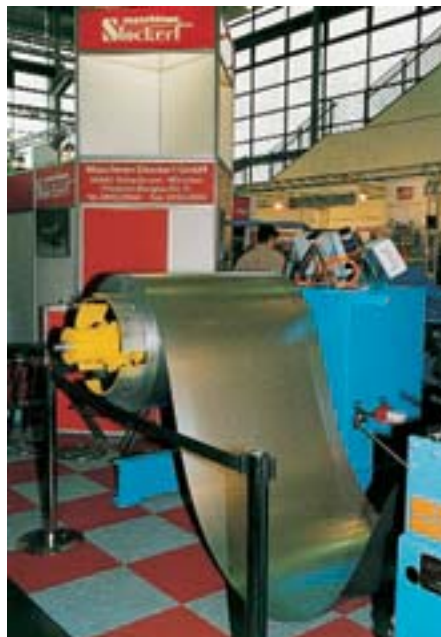
Maschinen Stockert aus Hohenbrunn zeigte neben anderen zahlreichen Maschinen eine integrierte Abrollhaspel für 5-Tonnen-Coils
