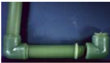
Bild 6 Unvollständige Verschweißung eines PP-Rohres mit dem Fitting
