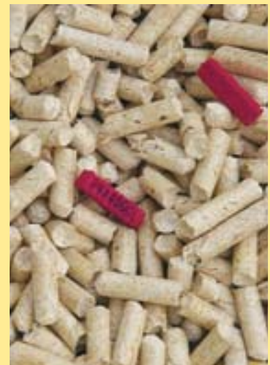
Codiersystem der Pelletsverbände PVD und PDA mittels farbiger Holzstückchen
