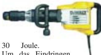
30 Joule. Um das Eindringen von Staub zu verhindern, ist das Hammerwerk mit einem neuartigen Staubschutz mit speziellen Dichtringen ausgestattet. Sichere Führung läßt sich der Abbruchhammer mit seinem großen, gummierten Hand- und Zusatz-Handgriff, der sich stufenlos um 360° drehen und beliebig befestigen läßt. Der Meißel kann durch einfaches Drehen des Arretierings in zwölf verschiedene Positionen fixiert werden.
