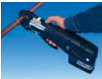
Etageninstallation oder die „kleine Baustelle“ bis Nennweite 28 bzw. 32 mm konzipiert wurde. Das ebenfalls neue Wechselbackenkonzept mit einer Grundbacke und Preßeinsätzen ermöglicht eine Ein-Hand-Bedienung und soll eine Alternative bei der Verwendung mehrerer Rohrsystem darstellen. Es eignet sich zum Verpressen von Kupfer, Rotguß und deren Legierungen sowie den Werkstoffen anderer Systemanbieter für die Gas-, Wasser- und Solarinstallation.
