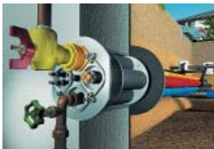
anderer Hersteller zu gewährleisten. Ermöglicht wurde dies durch die Entwicklung eines zweigeteilten Klemmverbinders, der durch einen Formschluß die Gas-Hauseinführung in der Quadro-Secura-MSE aufnimmt. Bei diesem Klemmverbinder werden die Auszugs- und Verdrehkräfte gemäß der VP-601/DVGW aufgenommen.
