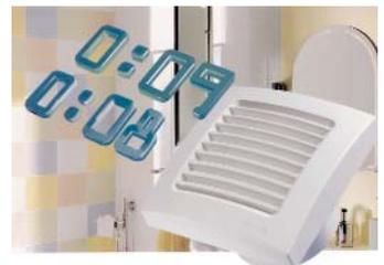
10 Minuten beträgt. Der Ventilator kann während eines Zeitintervalls manuell über einen Lichtschalter eingeschaltet werden. Er läuft dann mit einer Verzögerung von 50 Sekunden an. Nach dem Abschalten beginnt eine Nachlaufzeit von 10 Minuten. Auf Wunsch läßt sich die Intervallsteuerung auch ganz abschalten.
