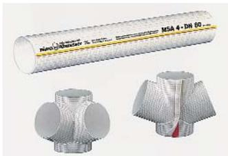
punkten verknottetes Gittergewebe, eine feuchtigkeitssperrende Polyethylen-Folie, eine Polsterlage aus reißfesten, miteinander vernadelten Kunststoff-Fasern und einen innenliegenden geschlossenzelligen Polyethylen-schaum. Die werkseitig vorgefertigten Schallschutz-Dämm-Manschetten sind auch für Gußrohrstücke DN 80 erhältlich.
