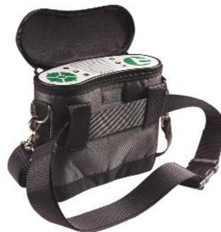
kunde auf ein Leck an und klingt auch nach der Detektion eines Groblecks schnell wieder ab. Das Gerät kommt ohne Pumpen oder andere bewegliche Teile aus und spricht sehr selektiv auf Wasserstoff an. Die Lecksuche wird von anderen Gasen nicht beeinträchtigt. Ein Aufladen der
