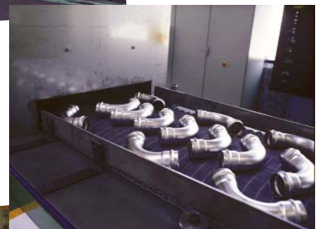
Die „Sanpress Inox“-Bögen auf dem Weg in den Glühofen
