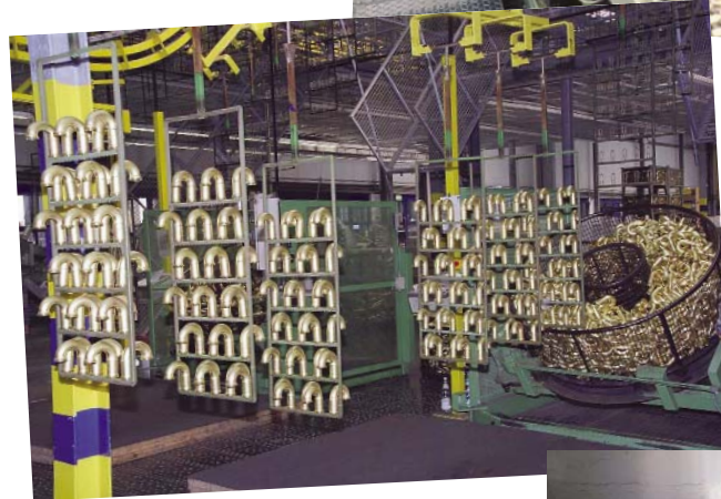
Auch die Siphonbögen werden in der hauseigenen Galvanik verchromt
