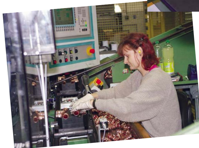
In der Kupfermontage wird jedes einzelne Produkt überprüft, mit der SC-Contur versehen, lasergekennzeichnet, das Dichtelement montiert und vollautomatisch verpackt
