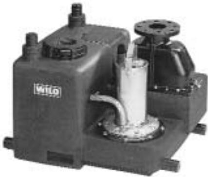
streifen sollen Schallübertragungen von Betriebsgeräuschen verhindern. Die DrainLift M gibt es als Einzel- und als Doppelpumpenanlage mit automatisch wechselndem Einsatz der beiden Pumpen, Reserve- sowie Spitzenlastbetrieb. Beide Anlagen haben einen maximalen Volumenstrom von 55 m<sup>3</sup>/h und eine maximale Förderhöhe von 7,5 m.
