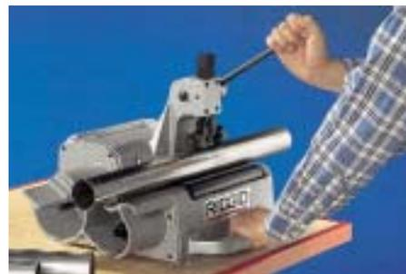
chen Innengrattentferner bietet Ridge Tool weitere Zubehöre für das Modell 122 an, mit denen sich auch Kupferrohre schneiden, säubern und entgraten lassen.
