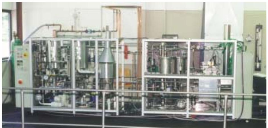
**Bild 7** Zukunftsmusik: Die „PEM-Brennstoffzellen-Hausenergieversorgungsanlage“ mit Erdgas-reformer bringt im Rahmen eines Pilotprojektes an der FH Ulm im Vollbetrieb 5 kW elektrische Leistung
