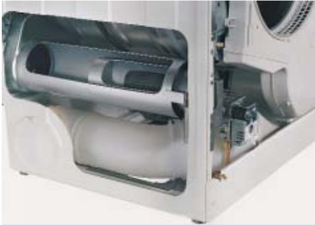
**Bild 3** Bei dem erdgasbetriebenen Wäschetrockner T 478 G von Miele handelt es sich um einen ganz normalen Ablufttrockner. Nach einer Sicherheitsroutine, die nach jedem Programmstart einsetzt, erfolgt automatisch die Zündung des Gasbrenners. Um die Brennkammer strömt Luft, die sich erwärmt und zum Trocknen der Wäsche in die Trommel geführt wird. Die Betriebstemperatur wird elektronisch durch Temperatur-
