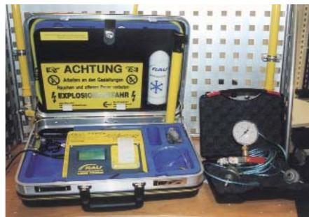
Abwasserleitungen. Das Prüfergebnis läßt sich als Prüfprotokoll über einen integrierten Nadeldrucker ausdrucken, wobei die Daten im Gerät gespeichert bleiben. Über ein serielles Kabel können diese Daten auf einen PC überspielt werden. Neben serienmäßigem Gerätezubehör zur Prüfung und Druckmessung an Gasleitungen sowie zur Leckmengenmessung, sind optional Erweiterungssätze für das Prüfen von Trinkwasserleitungen und Abwasser-Grundleitungen erhältlich.
