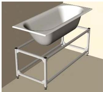
Höhe verstellbar. Mit nur vier neuen Bauteilen lassen sich fast alle Wannentypen aufbauen und mit Ablagen, Schrank- oder Regaleinbauten ergänzen. Zur Schallentkoppelung der Badewanne sind die tragenden Endkappen des Wannengestells mit einem Schallschutzgummi versehen. Zur zusätzlichen Entkoppelung des Wannenrandes wird die Montage eines geteilten Wannendämmbandes mit einer Abrißkante empfohlen.
