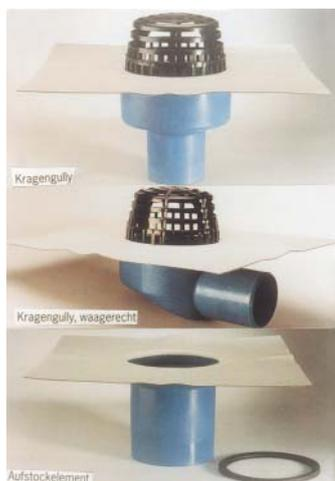
sentliche Dichtungsrolle bei der Verwendung von Aufstockelementen, die bei Warmdächern und bei Sanierungen zur Anwendung gelangen. Eine speziell geschaffene Rückstausicherung legt sich in die Nute und soll somit die Verbindung absolut dicht und rückstausicher machen. Die aus FCKW-freiem PUR-Integral-Hartschaum gefertigten Gullys werden in den
