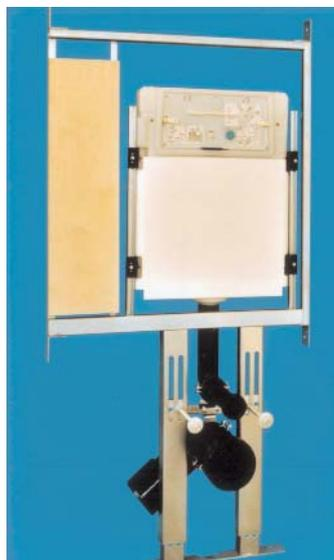
Rahmenkonstruktion mit geschweißten Profilstahlrohren. Vorgeschriebene Achsabstände für die Montage von Stützgriffen an behindertengerechten WC-Anlagen lassen sich durch die Platzierung des Tragständers in Ecknähe und durch die Montage eines Wandgriffes an der flankierenden Wand erreichen.
