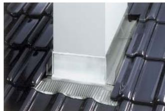
schnellen und einfachen Einbau mit geringem Löt- oder Klebeaufwand. Den Anschlußrahmen gibt es in zwei Varianten für die gängigen Dachneigungsbereiche von 10° bis 35° sowie 36° bis 60°. Die erste Variante ist ausgelegt für Schornsteinbreiten bis zu 1 m Breite und 0,8 m Tiefe, die zweite für dieselbe Breite und für 0,5 m Tiefe. Für den traufseitigen Anschluß an unter-
