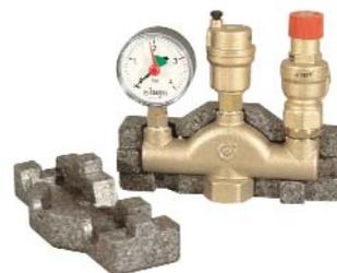
einem Manometer sowie mit einem Schnellentlüfter, der mit einer seitlichen Schwimmerhalterung und einer automatischen Absperrung ausgestattet ist. Eine Zwangsentlüftungsführung soll für eine schnellere Luftzuführung zum Entlüfter sorgen. Das Heizungsmanometer mit grüner Fahne weist ebenfalls ein automatisches Absperrventil auf. Die Lieferung der neuen Kesselgruppe erfolgt inklusive Isolierung.
