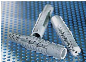
ein Tieferrutschen im Bohrloch. Sägezähne und Sperrkanten unterbinden ein unangenehmes Mitdrehen im Bohrloch, auch bei ausgefransten Löchern. Seine schrägen Verbindungsstege ermöglichen eine erwünschte Schraubenführung. Dadurch verringert sich die Torsion beim Eindrehen der Schraube und der Dübel zieht. Eine Einschlagsperre sorgt zudem dafür, daß der UX auch bei Durchsteck-
