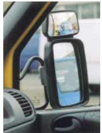
Weitwinkelspiegel für den Mercedes-Benz Sprinter
