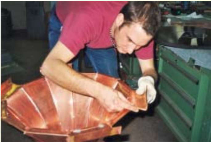
Die 3 mm hohen Falze des Säulenkörpers liegen außen und wurden innen punktuell mit Weichlot geheftet, ...
