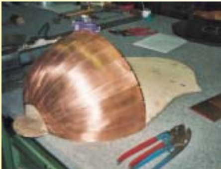
Der Außenmantel der 16teiligen \frac{1}{4} -Kugel mit Börtelnaht ist von innen Wig-geschweißt
