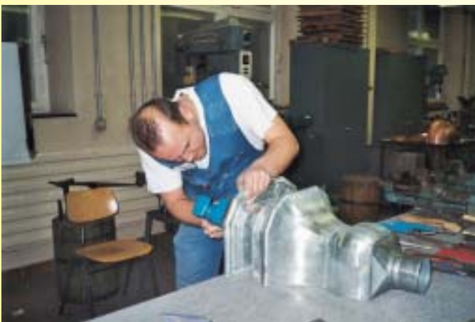
. . . an dem ein Stutzen von 98 mm Durchmesser, durch einen 5 mm hohen Falz verbunden wurde
