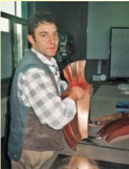
Die elf einzelnen Segmente sind durch innenliegende Falze miteinander verbunden
