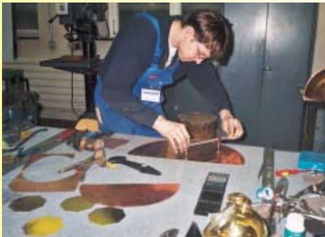
Die Rückwand aus Holz wurde mit einem 1,0 mm dickem Kupferblech bekleidet
