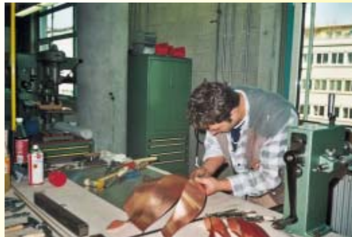
Der Boden ist eingefalzt und leicht gewölbt
