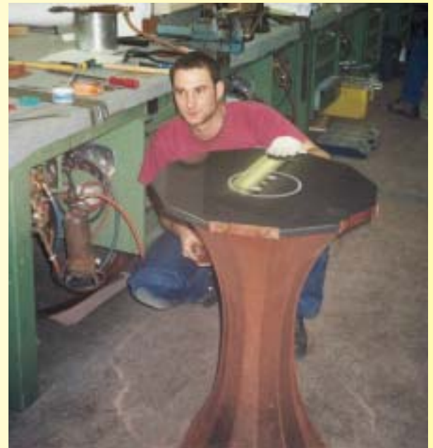
... bevor die Granitplatte in einer Stärke von 20 mm aufgelegt wurde
