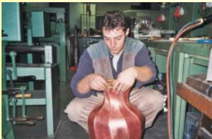
Der obere Abschluß besteht aus genuteten und auf Gehrung gesägten Messing-rohren, die an den Stößen mit Silberlot hartgelötet wurden
