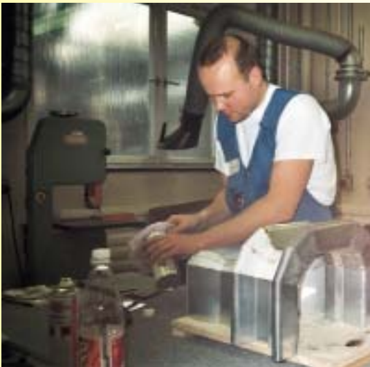
Die an den Gehrungen stumpf gestoßenen Segmente sind durch eine Tropfnahnt miteinander verbunden
