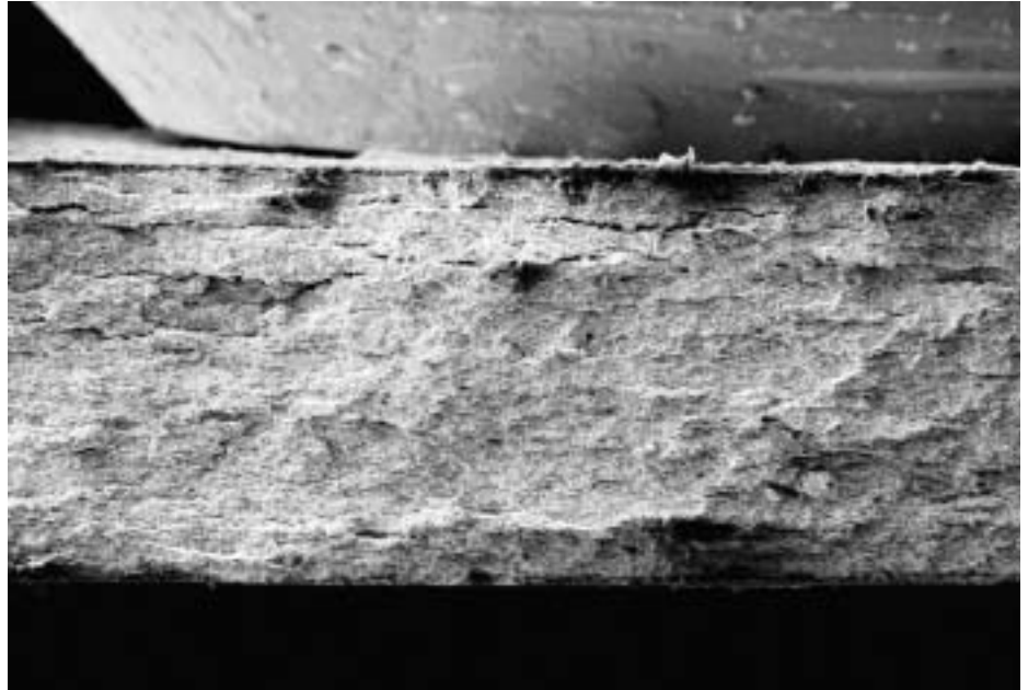
Die von Hand gebrochene Probe zeigt bei 100facher Vergrößerung einen glatten Bruch über den gesamten Querschnitt
