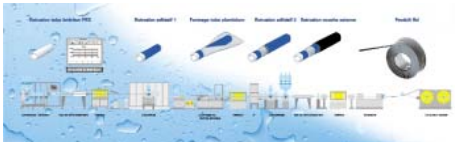
Die Produktion des Verbundrohres erfolgt in sechs Schritten: Wareneingangsprüfung, Rohrherstellung, Vernetzung, Schlußprüfung, Verpackung und Versand
