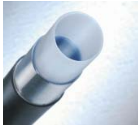
Mehrschichtiges Verbundrohr mit Innenrohr aus vernetztem Polyethylen, Aluminiumrohr und Schutzschicht aus PE-HD
