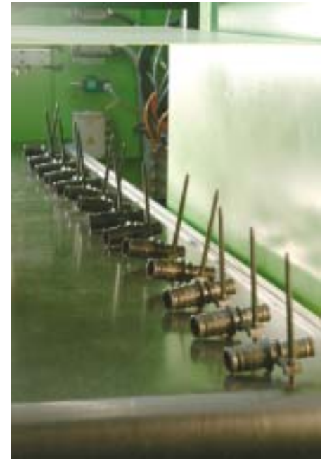
Moderne Anlagen sorgen für die weitgehend automatisierte Herstellung von Mepla-Fittings
