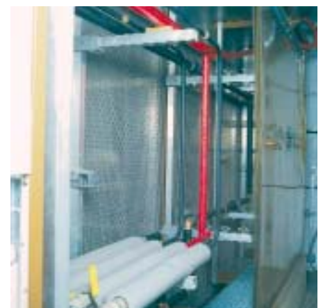
In der Temperaturwechsellanlage werden Temperaturwechselprüfungen als Extremtests für Rohr, Verbinder und PVDF-Fitting durchgeführt
