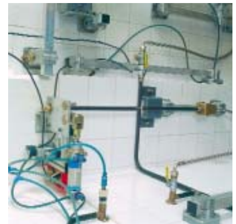
Biegewechselversuch und Torsionsversuch nach DVGW-Arbeitsblatt 534 sowie herstellerinterne Tests zeigen die Belastbarkeit der Verbindungen bei mechanischen Beanspruchungen
