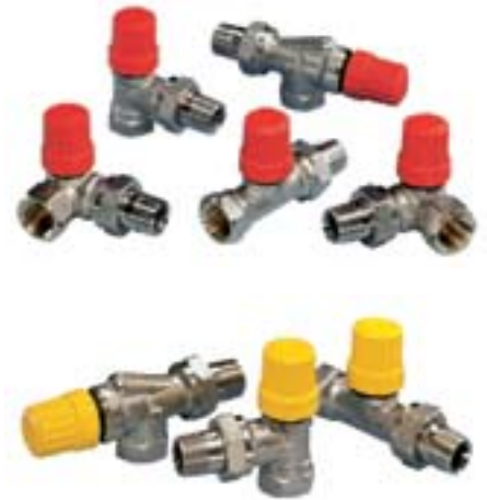
Bild 1 Mit den Ventilen RA-N (I.) und RA-UN lassen sich bei mittleren Druckverlusten von 100 mbar Volumenströme von 6–230 l in kleinen Abstufungen einstellen
