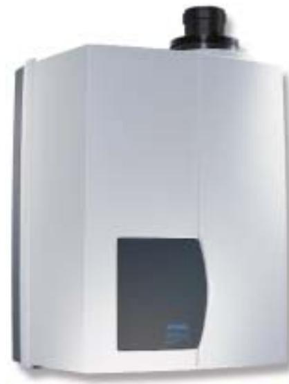
Der SonnenGasCombi HR-SGC vereint in der Kombination HR 5000 Brennwertkessel mit einem 200 l Edelstahlspeicher als Kompaktgerät die Nutzung der Solarenergie für Warmwasser und Heizung. Der Brenner im Kessel moduliert stufenlos von 3,9 bis 23 kW.
