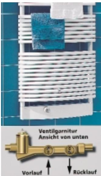
**Ventilgarnitur mit Mittelan-schluß: Vor- und Rücklauf lassen sich durch Versetzen der Gewindestifte leicht austauschen**
