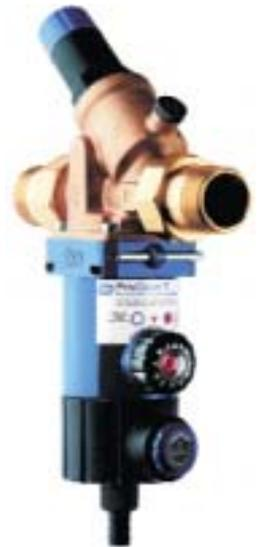
Kugelhahn zur Bedienung freigegeben. Durch eine Viertelumdrehung nach rechts wird das Rückspülventil geöffnet. Gleichzeitig kann durch Drehen des unteren schwarzen Gehäuseteils der Schmutz vom Filterelement gelöst werden. Außerdem neu im Syr-Programm: Flanschdruckminderer mit den bekannten Druckminderkartuschen des Herstellers in den Größen DN 65, 80 und 100.
