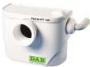
12 cm Abflußhöhe angeschlossen werden. Die technischen Daten lauten: 650 Watt Motorleistung, 4,2 m<sup>3</sup>/h Fördermenge und 6,5 m Förderhöhe.
