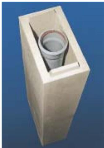
und einer Leistung bis zu 35 kW. Die einzelnen Elemente bestehen aus Schaumkeramik und Polypropylen. Die Ummantelung erfüllt den gesetzlich vorgeschriebenen Feuerwiderstandsschutz F 30 bei Gebäuden mit geringer Bauhöhe. Für alle möglichen Feuerungsarten stehen entsprechende Schacht- oder Schornstein-Lösungen bereit.
