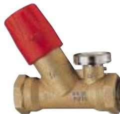
steht aus Ametal-C, einer korrosions- und entzinkungsresistenten Legierung, und ist somit nach Herstellerangaben für den Einsatz in Trinkwasserleitungen geeignet. Durch eine manuelle Absperrung können Reparaturarbeiten im System ausgeführt werden. TA-Therm ist werkseitig kalibriert und auf einen Sollwert von 55 °C eingestellt. Dieser Sollwert kann jedoch während des Betriebes zwischen 35 und 65 °C verändert werden.
