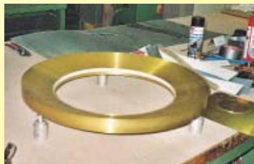
*. . . bevor sie mittels acht Rauten aus Messing-Vollmaterial mit der Unterkonstruktion von unten verschraubt wird*
