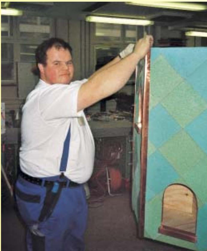
*Simse und Fenstereinfassungen sind aus walzblankem Material. An den Außenkanten sind die senkrechten Eckabdeckungen eingefalzt*
