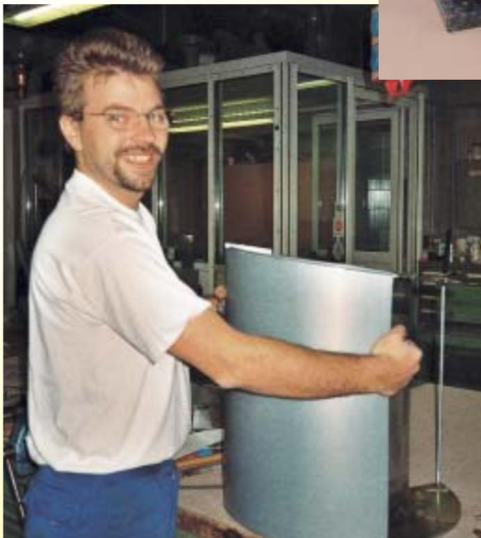
*Der am oberen Abschluß doppelt und am Boden einfach gefalzte Korpus aus vorbewittertem Titanblech, wird mit der Unterkonstruktion zusammengefügt . . .*
