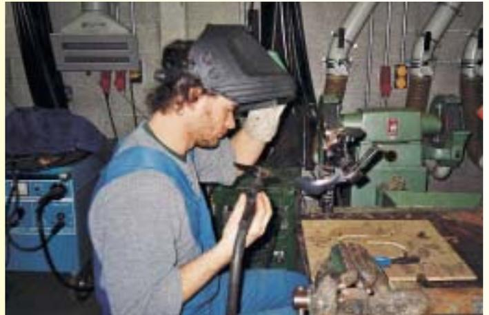
▲ Die beiden getriebenen Halbschalen des Fisches werden mit einer WIG-Schweißnaht verbunden
