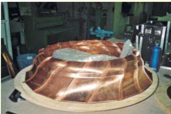
*Durch außenliegende Stehfalze, die innen zusätzlich durch Weichlöten gesichert sind, werden die 17 Segmente des Roulettekessels zusammengehalten*
