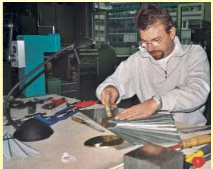
*. . . bevor das Dach mit strahlenartigem Falzverlauf von einem Messing-Halbkreis ausgehend eingefalzt wird*
