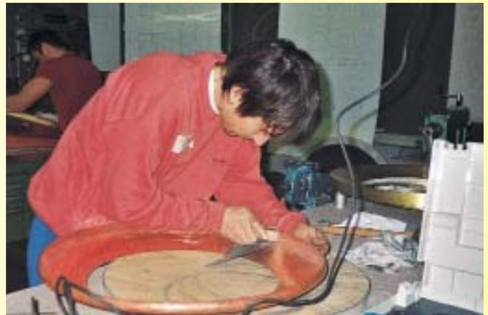
*Der stumpf zusammengeschweißte Stoß der Lauffläche wird abgeschliffen und die Rundung abgeschlichtet . . .*
