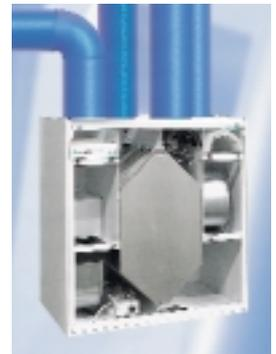
der Kreuzgegenstrom-Wärmerückgewinner soll einen Wirkungsgrad von über 90 % aufweisen. Ein Feuchte- und/oder CO<sub>2</sub>-Fühler steuert das Gerät automatisch in Abhängigkeit der Raumluftqualität in acht Stufen, auf Wunsch digital. Das Gerät ist LON- und EIB-busfähig, außerdem besitzt es eine automatische und temperaturgesteuerte Sommer/Winterschaltung.
