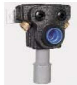
das Zentrieren und Einbauen des Abflußrohres. Eine gesonderte Schall- und Wärmedämmung ist nach Herstellerangaben nicht nötig, da es sich hierbei um eine kompakte schall- und wärmeentkoppelte Anschluß-Box handelt. Das Stichmaß von 60 mm ermöglicht eine nachträgliche Installation von Halbsäulen. Erhältlich ist die Sanibox 3 mit Press Anschluß, in Rotguß Serie 3000 sowie mit Gewindeanschluß und cuprofit-Steckanschluß. Eine Drei-Loch-Rosette ermöglicht die Abdeckung der Anschlüsse.
