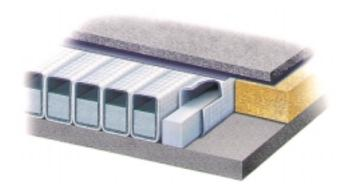
Bei den allgemein gebräuchlichen asymmetrischen Dämmungen wird die Gleichwertigkeit zur konzentrischen Dämmung mit einer Dämmdicke von 13 mm hergestellt
